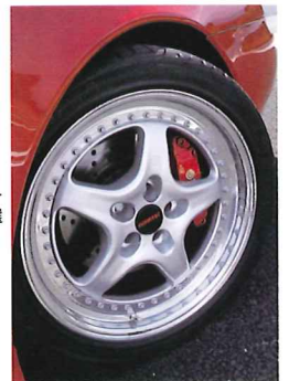
コンプリートモデルのホイールはノヴィテックN3の8.0x18(ET30)が標準。ユーザーの好みで17インチの選択もできる。
