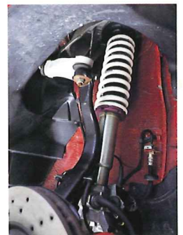
オリジナルスペックの減衰力固定式ダンパーに直巻スプリングを組み合わせた車高調キット(245,000円)。35mm以上のローダウンに。
